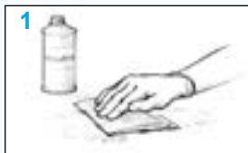
Abbildung 6 Reinigen Sie die Fläche. Entfernen Sie ggf. alle Verunreinigungen mit einem Lösungsmittel.
