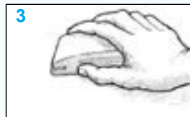
Abbildung 6 Reinigen Sie die Fläche. Entfernen Sie ggf. alle Verunreinigungen mit einem Lösungsmittel.
