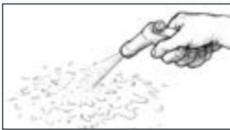
Abbildung 33 Waschen Sie die Oberfläche nach dem Schleifen mit Wasser ab.
