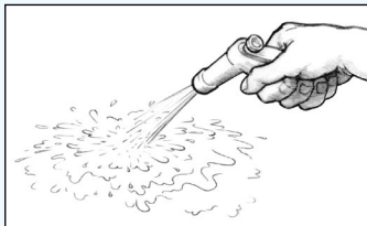
Figur 33 Tvätta ytan med färskvatten efter slipning.
