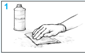
Figur 6 Rengör ytan. Använd vid behov aceton alt. WEST SYSTEM 850 för att avlägsna föroreningar.
