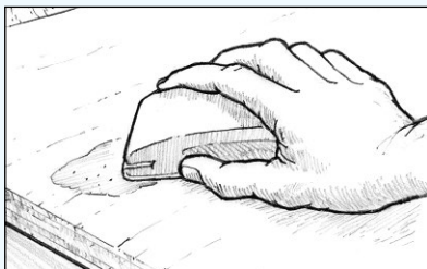
Figur 23 Slipa spacklet jämnt med omgivande yta.
