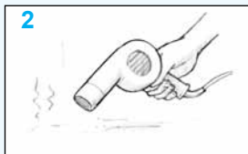
Figura 7 Seque la superficie. Deje que se sequen totalmente las superficies mojadas, o utilice calor o un ventilador para acelerar el secado.
