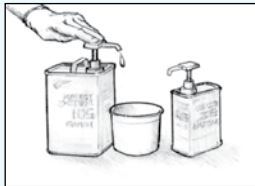
Figura 2 Dosifique la proporción correcta de resina y endurecedor.
