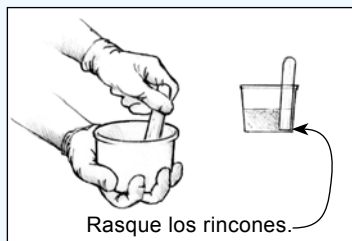
Figura 3 Mezcle la resina y el endurecedor completamente durante 2 minutos, más tiempo con temperaturas bajas.
