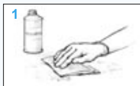
Slika 6 Očistiti površinu. Koristiti razređivač, ako je potrebno, za uklanjanje svih nečistoća
