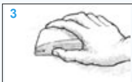
Slika 8 Šmirglanje neporoznih površina, za bolje prodiranje epoksida u strukturu materijala
