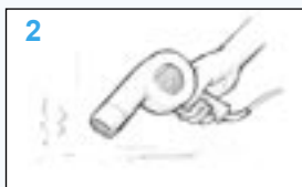
Slika 7 Osušiti površinu. Pustiti površinu da se osuši ili sušenje ubrzati izvorom toplog vazduha
