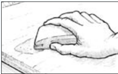
Slika 23 Išmirglajte očvrslu smesu dok ne dobijete željenu konturu
