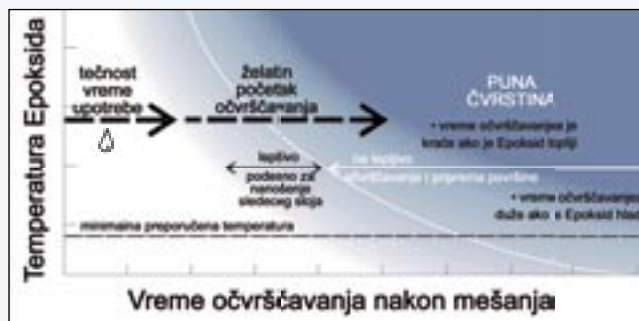
SLIKA 1. Prilikom očvršćavanja epoksid prolazi kroz tri faze: tečnu, želatin i čvrstu.
