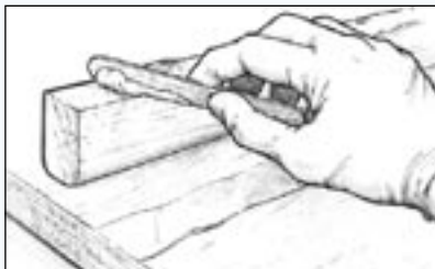
Slika 10 Nanesite ugušćen epoksid na jednu površinu
