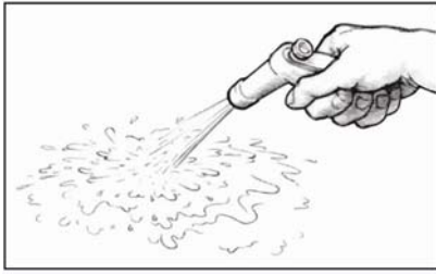
Рис. 33. После шлифовки промойте поверхность пресной водой.
