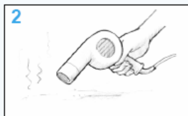
Рис. 7. Высушите поверхность. Дайте влажной поверхности просохнуть или используйте фен для ускорения процесса.
