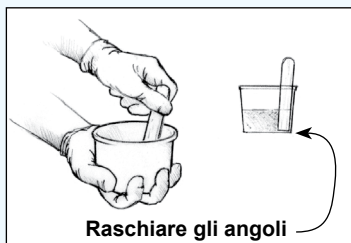
Figura 3 Mescolare bene la resina e l'indurente per 2 minuti, più a lungo se si lavora a basse temperature.
