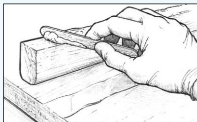
Figura 10 Applicare la resina addensata su una delle superfici di assemblaggio.
