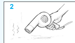
Figura 7 Asciugare la superficie. Lasciare asciugare completamente le superfici bagnate oppure utilizzare una fonte di calore o un ventilatore per velocizzare l'asciugatura.
