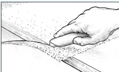
Figura 25 Tagliare il tessuto in eccesso dopo che la resina epossidica ha gelificato ma prima che catalizzi completamente.
