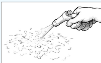
Figura 33 Dopo la carteggiatura sciacquare la superficie con acqua dolce.
