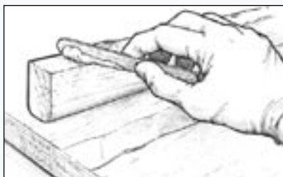
Σχήμα 10 Εφαρμόστε το παχυμένο εποξειδικό μίγμα σε μία από τις επιφάνειες συγκόλλησης.
