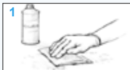
Σχήμα 6 Καθαρίστε την επιφάνεια. Εάν είναι απαραίτητο, χρησιμοποιήστε ένα διαλύτη για να απομακρύνετε όλους τους ρύπους.
