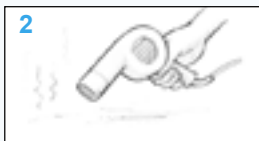
Σχήμα 7 Στεγνώστε την επιφάνεια. Αφήστε τις υγρές επιφάνειες να στεγνώσουν καλά ή χρησιμοποιήστε θερμότητα ή ανεμιστήρα για την επιτάχυνση της ξήρανσης.
