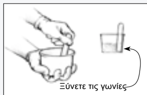
Σχήμα 3 Αναμίξτε πλήρως τη ρητίνη και το σκληρυντικό επί 2 λεπτά (ή περισσότερο, σε συνθήκες χαμηλής θερμοκρασίας).
