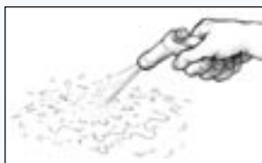
Σχήμα 33 Ξεπλύνετε την επιφάνεια με καθαρό νερό μετά τη λείανση.
