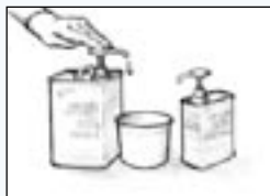
Σχήμα 2 Δοσομετρήστε τη σωστή αναλογία ρητίνης και σκληρυντικού.
