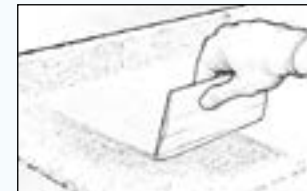
Abbildung 24 Entfernen Sie überschüssiges Epoxidharz mit einem Spachtel, bevor es in den Geleezustand übergeht.
