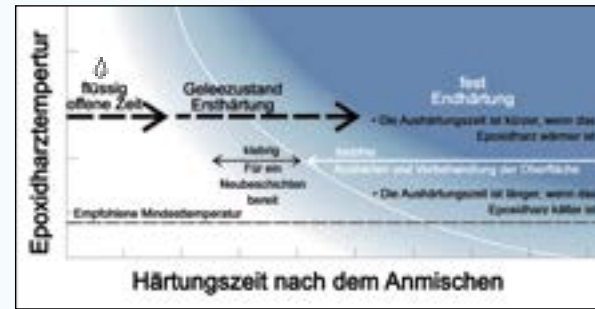
Abbildung 1: Beim Aushärten wechselt das angemischte Epoxidharz von einem flüssigen erst in einen geleeartigen und dann in einen festen Zustand.
