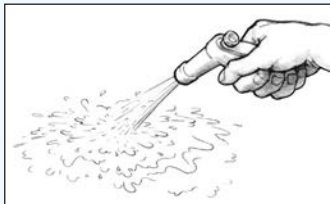
Figure 33 Rincer la surface avec de l'eau fraîche après ponçage.
