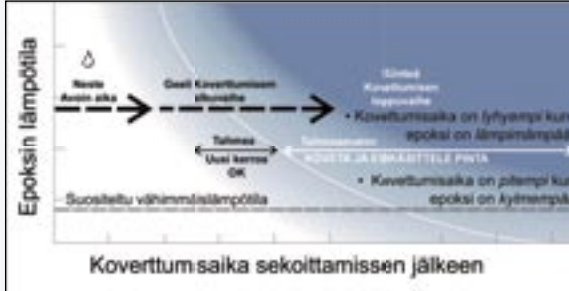
Kuva 1 Kun epoksiseos kovettuu, se siirtyy nestemäisestä tilasta ensin geelimäiseen ja sitten kiinteään.
