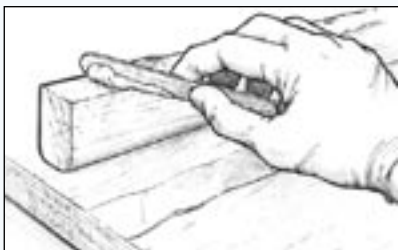
Kuva 10 Levitä saostettua epoksia toiselle liimattavista pinnoista.
