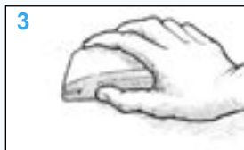
Kuva 8 Hio ei-huokoiset pinnat. Luo pintarakenne, johon epoksi voi kiinnittyä mekaanisesti.
