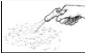
Kuva 33 Huuhtelee pinta puhtaalla vedellä hiomisen jälkeen.
