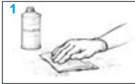
Figuur 6 Reinig het oppervlak. Gebruik indien nodig een oplosmiddel om al het vuil te verwijderen.
