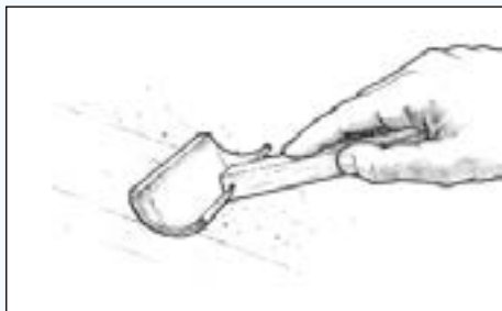
Figuur 31 Strijk de coating af door met een schuimkwast licht over de verse epoxy te gaan.
