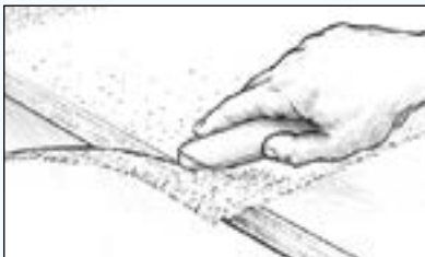
Figuur 25 Snij overtollig glasweefselmat weg nadat de epoxy begint te geleren.
