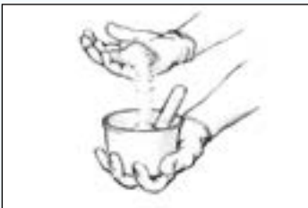
Figuur 4 Voeg steeds kleine hoeveelheden van het vulmiddel toe totdat het mengsel de gewenste dikte heeft bereikt.
