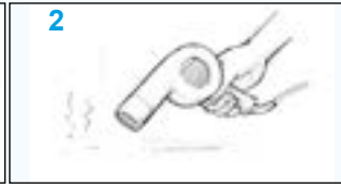
Figuur 7 Droog het oppervlak. Laat een vochtig oppervlak goed drogen, gebruik zonodig een warmtebron of een ventilator om het drogen te versnellen.
