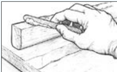
Figuur 10 Breng een laag verdikte epoxy aan op één van de delen die verlijmd worden.
