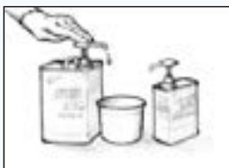
Figuur 2 Doseer de correcte hoeveelheden hars en verharder.
