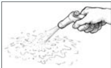
Figuur 33 Spoel na het schuren het oppervlak af met schoon leidingwater.
