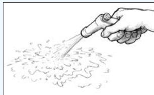
Figur 33 Rengør overfladen med rent vand efter slibningen.
