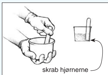
Figur 3 Rør resin og hærder godt sammen i 2 minutter, længere ved lavere temperaturer.
