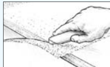
Slika 25 Višak platna odstraniti skalpelom posle gel faze, ali prije potpunog otvrdnjavanja
