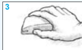
Slika 8 Brušenje površine za što bolje prodiranje smjese u površinu
