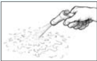
Slika 33 Oprati površinu vodom poslje brušenja.
