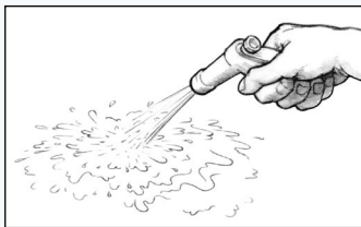
Figur 33 Tvätta ytan med färskvatten efter slipning.
