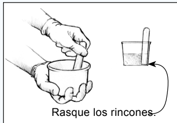
Figura 3 Mezcle la resina y el endurecedor completamente durante 2 minutos, más tiempo con temperaturas bajas.
