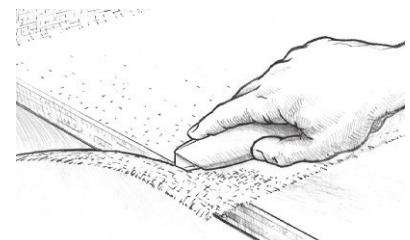
Figura 26 Recorte el exceso de tela después de que el epóxico gelifica.
