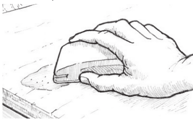
Figura 8 Lijar las superficies no porosas. De esa forma se crea una textura para que el epóxico muerda.
