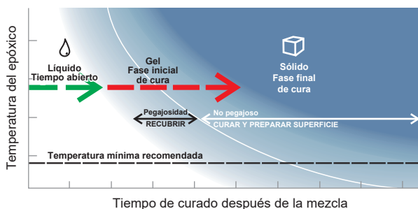
Figura 1 A medida que cura, el epóxico mezclado pasa de un estado líquido, a un estado de gel y luego al estado sólido.
