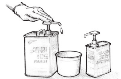
Figura 2 Dosifique las proporciones adecuadas de resina y endurecedor. Con mini bombas — accione un golpe completo de la bomba de resina para cada golpe completo de la bomba de endurecedor.
