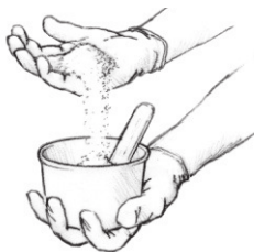
Figura 5 Mezcle pequeños puñados de relleno hasta alcanzar la consistencia deseada.
