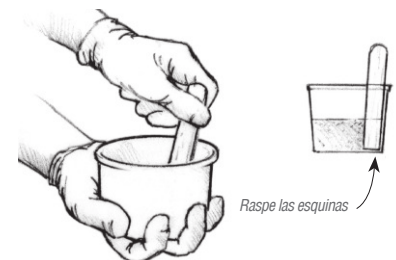
Figura 3 Mezcle la resina y el endurecedor juntos — por lo menos 1 minuto, durante más tiempo en temperaturas más frías.
