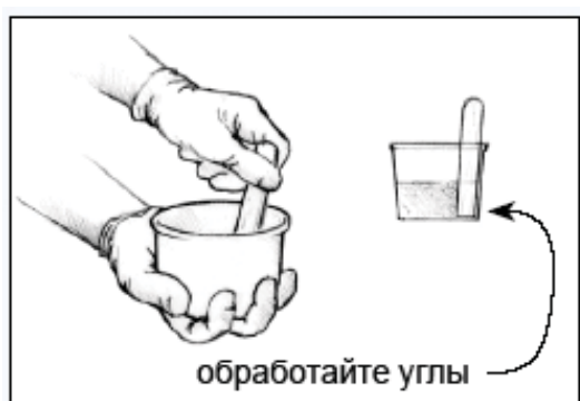
Рис. 3. Тщательно перемешивайте оба ингредиента на протяжении 2 минут или дольше при низких температурах.
