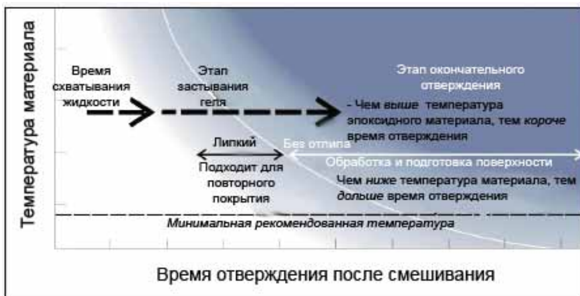
Рис.1. По мере отверждения, смешанная эпоксидная смола переходит из жидкого состояния в состояние геля, а затем – в твердое.
