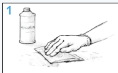
Рис. 6. Очистите поверхность. При необходимости используйте растворитель для удаления всех загрязнений.
