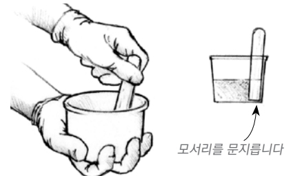
그림 3 수지와 경화제를 충분히 뒤섞습니다. - 최소 1분간, 더 낮은 온도에서는 더 오래 실시합니다.
