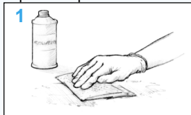
Figura 6 Pulire la superficie. Se necessario, utilizzare un solvente per rimuovere ogni minima traccia di agente contaminante.
