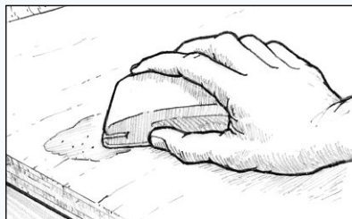
Figura 23 Carteggiare lo stucco catalizzato secondo il contorno desiderato.
