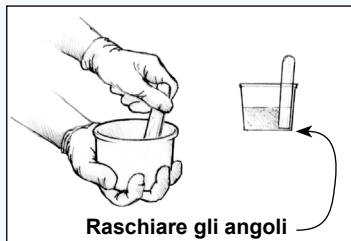
Figura 3 Mescolare bene la resina e l'indurente per 2 minuti, più a lungo se si lavora a basse temperature.
