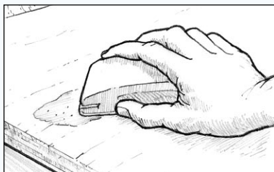
Σχήμα 23 Τρίψτε το υλικό εξομάλυνσης με γυαλόχαρτο, για να δώσετε στην επιφάνεια το επιθυμητό περίγραμμα.
