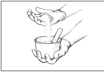
Abbildung 4 Mischen Sie geringe Mengen des entsprechenden Füllstoffs bei, bis Sie die gewünschte Konsistenz erzielt haben.
