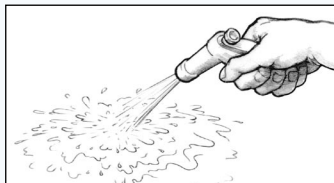
Abbildung 33 Waschen Sie die Oberfläche nach dem Schleifen mit Wasser ab.
