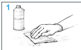
Figure 6 Nettoyer la surface. Utiliser, si nécessaire, un solvant pour enlever toutes les contaminations.
