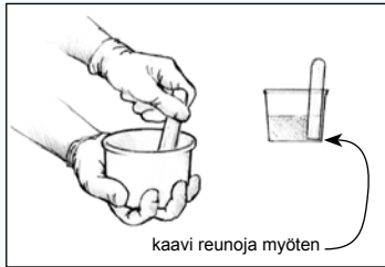
Kuva 3 Sekoita hartsia ja kovetetta perusteellisesti kahden minuutin ajan, pitempään viileissä lämpötiloissa.
