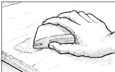
Figuur 23 Schuur de uitgeharde plamuur in de gewenste vorm.
