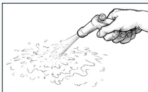
Figur 33 Rengør overfladen med rent vand efter slibningen.
