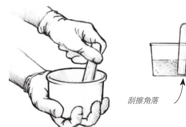
图3 在更低温度下充分搅拌树脂与硬化剂，持续至少一分钟。
