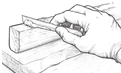
图10 将增稠的环氧树脂涂在其中一个粘合表面上。
