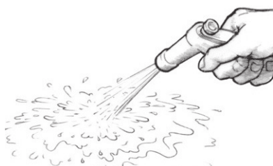
图33 打磨后,用清水冲洗表面。
