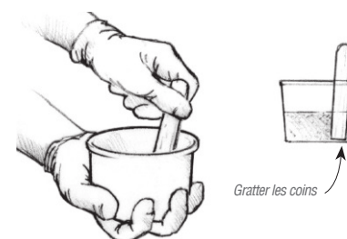
Figure 3 Mélangez résine et durcisseur ensemble vigoureusement - au moins 1 minute, plus longtemps sous température plus froide.
